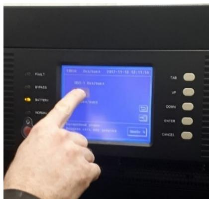
Наличие многофункционального 5,7-дюймового сенсорного ЖК-экрана с поддержкой русского языка, кнопки управления. Индикация режимов и параметров работы. Мнемосхема работы ИБП.
