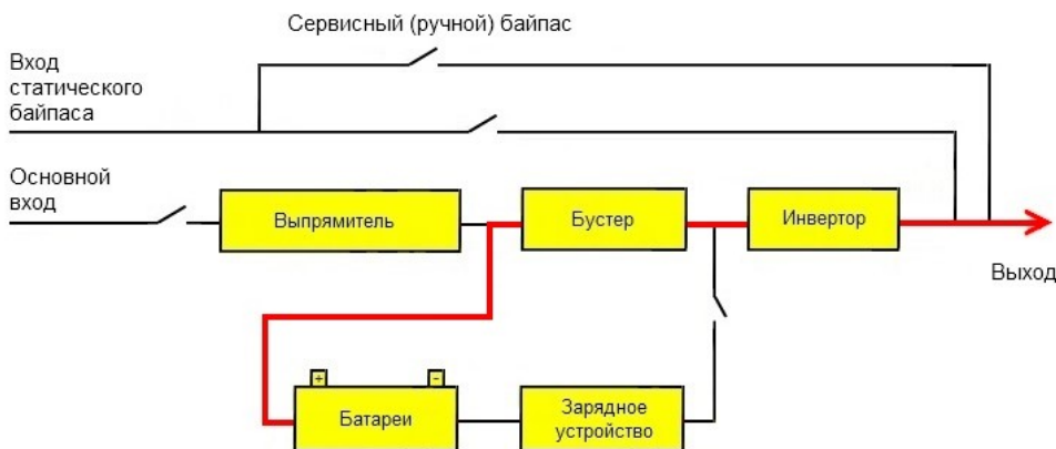
Схема работы в режиме от батарей.
